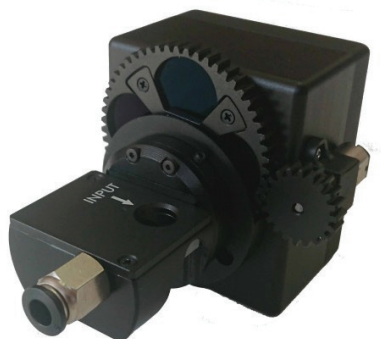
איור 7: BeamOn U3 High-Power Beam-Profiler - נתח אלומות בעוצמה גבוהה במיוחד משולב עם דוגם אלומה ואלמנט קירור בלחץ גבוה. באדיבות Duma Optonics.
